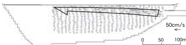
図 6.13: 実測流況(2号取水口中央)
